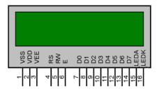
Fig. 3.1.4: 16\*2 LCD Display
