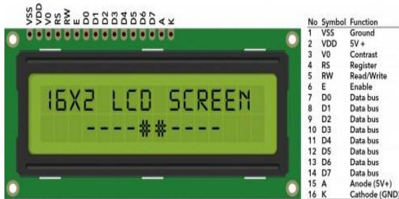
Fig6. LCD Display 16x2
