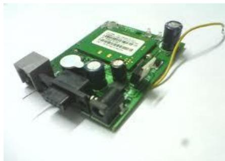
FIG 7:GSM Modem.
